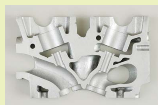
一般的な低圧鋳造法で生産された製品の断面(厚肉)
