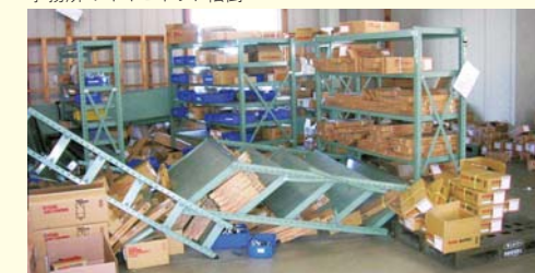
倉庫のスチール棚の転倒
