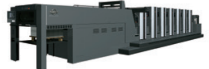
パッケージ印刷に対応するニスコーティングユニット搭載 B1サイズ6色機1060LXモデル
